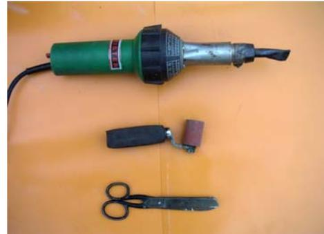
Werkzeug zur Reparatur der Mehrzweckplane
