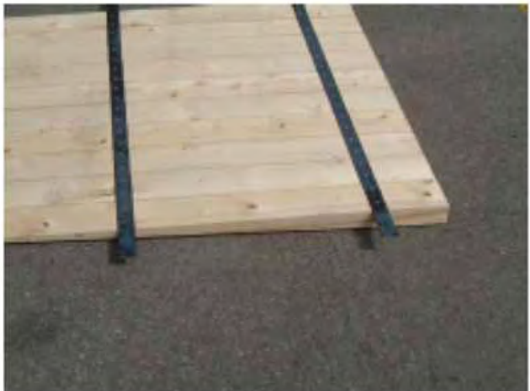
Die Rampe liegt hier auf dem Rücken, d.h. die Flacheisen liegen normal unten und dienen auch der Befestigung auf dem Boden, z.B. mit Schrauben und Dübeln.
