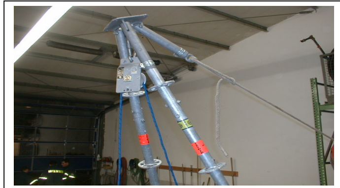
Mastkran mit angeschlagenem Rollgliss-Gerät und Abspannung . Wird der Mastkran zur Personenrettung eingesetzt, ist als Abspannung immer ein Greifzugseil (alternativ Stahlstropp oder Kette) zu verwenden. (Abb. III / 7)
